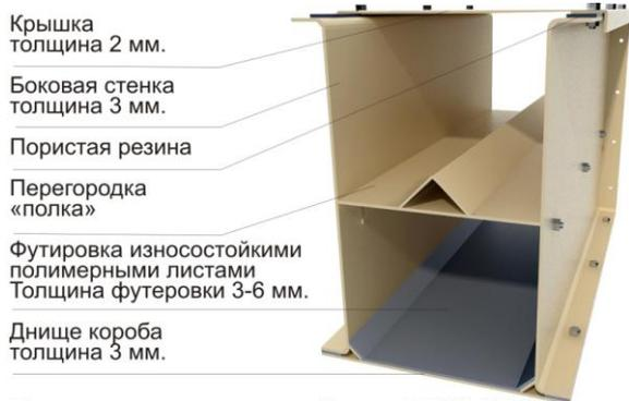
Разрез секции конвейера 2ТСЦ(ЗС)
